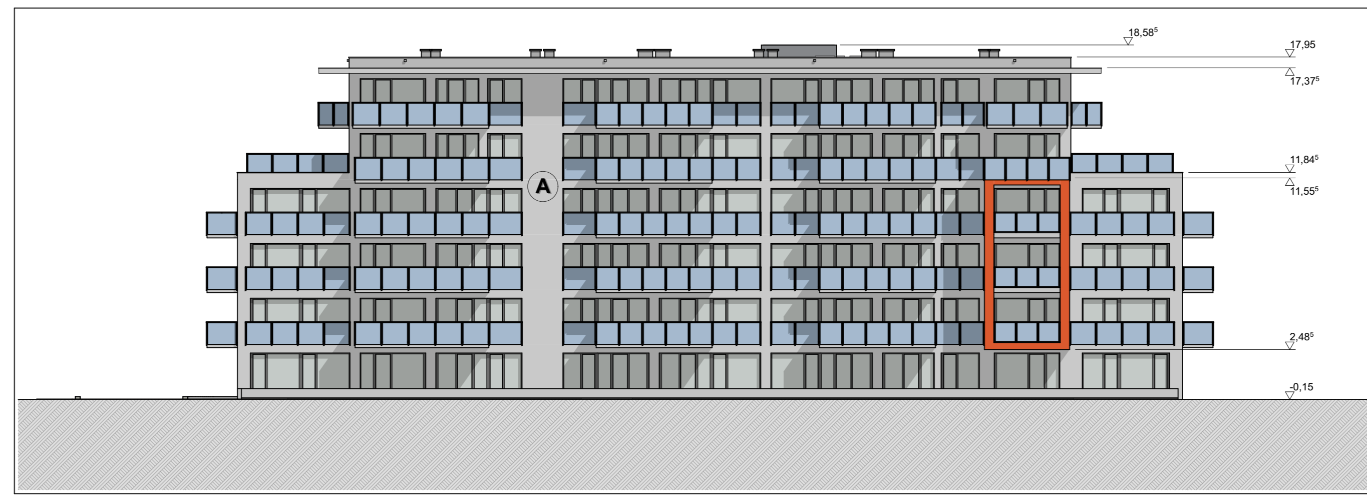
SKALA 1:200 POŁUDNIOWA ELEWACJA
